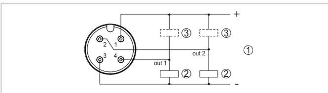
Anschlussplan M12 x 1-Stecker - Transistorausgang, Dreileiter
