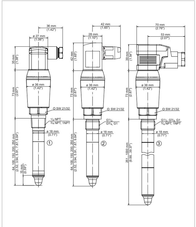
VEGAPOINT 23, modelo padrão - Rosca, com conector de válvula conforme ISO 4400
