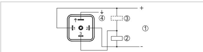
Anschlussplan ISO 4400-Stecker - Transistorausgang, Dreileiter
