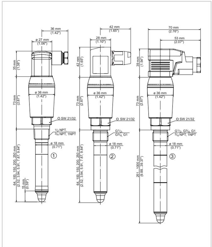
VEGAPOINT 23, Standardausführung - Gewinde, mit Ventilsteckern nach ISO 4400
