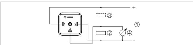
Esquema de conexiones - tres hilos 1 x transistor o 4 ... 20 mA
