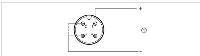
Schema di collegamento - bifilare 4 ... 20 mA - connettore M12 x 1
