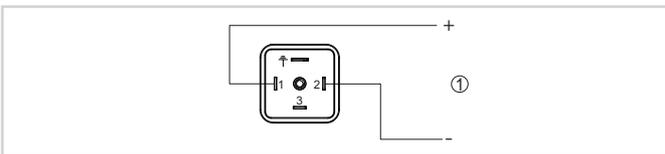
Schéma de raccordement - deux fils 4 ... 20 mA - connecteur selon ISO 4400
