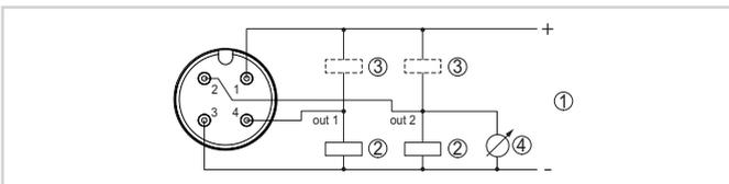
Esquema de conexiones - tres hilos con IO-Link (2 x transistor o 4 ... 20 mA más 1 x transistor)
