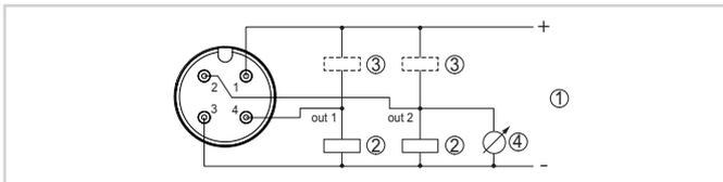
Schema di collegamento - trifilare con IO-Link (2 transistor o 4 ... 20 mA più 1 transistor)
