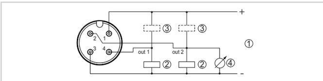
Esquema de conexiones - tres hilos con IO-Link (2 x transistor o 4 ... 20 mA más 1 x transistor)
