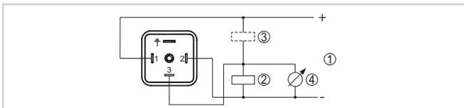
Anschlussplan - Dreileiter 1 x Transistor oder 4 ... 20 mA
