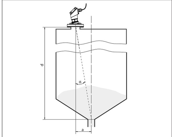
Abb. 15: Vorschlag für den Einbau nach Ausrichtung VEGAPULS 21
