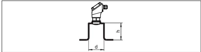
Abb. 11: Rohrstützenmontage
