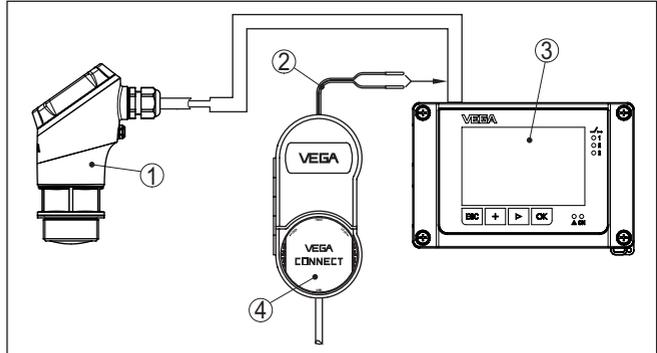
Abb. 26: Anschluss des PCs an das Steuergerät VEGAMET
