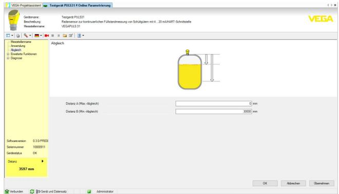
Abb. 24: Beispiel einer DTM-Ansicht - Inbetriebnahme Sensorabgleich
