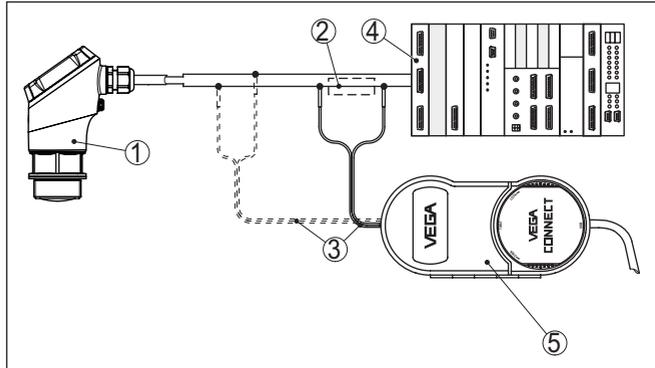
Abb. 25: Anschluss des PCs an die Signalleitung
