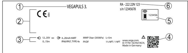
Abb. 2: Aufbau des Typschildes (Beispiel)
