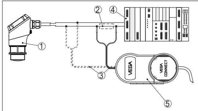
Abb. 4: Anschluss des PCs an die Signalleitung
