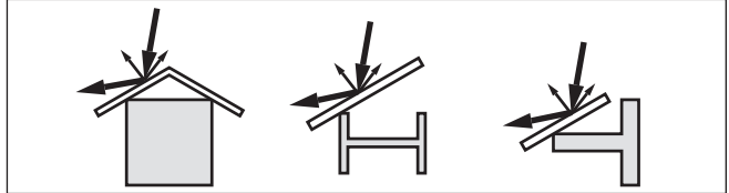
Abb. 13: Glatte Profile mit Streublenden abdecken
