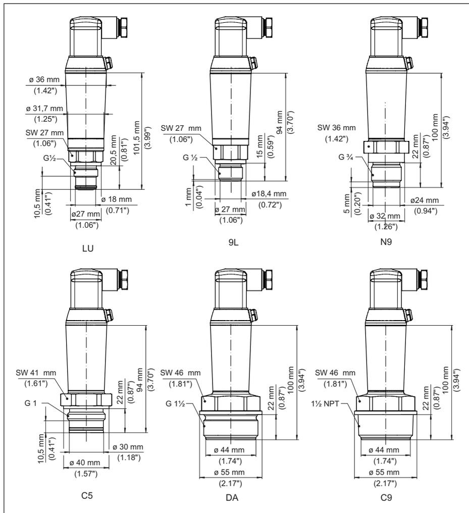
Fig. 31: VEGABAR 29, conexão rosca embutida na frente
