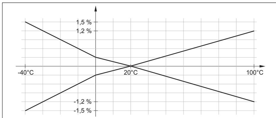
Fig. 26: Erro de temperatura em TD 1 : 1
