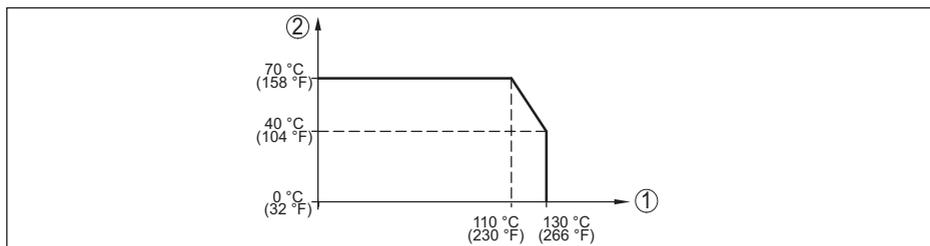
Fig. 27: Degradação da temperatura VEGABAR 29
