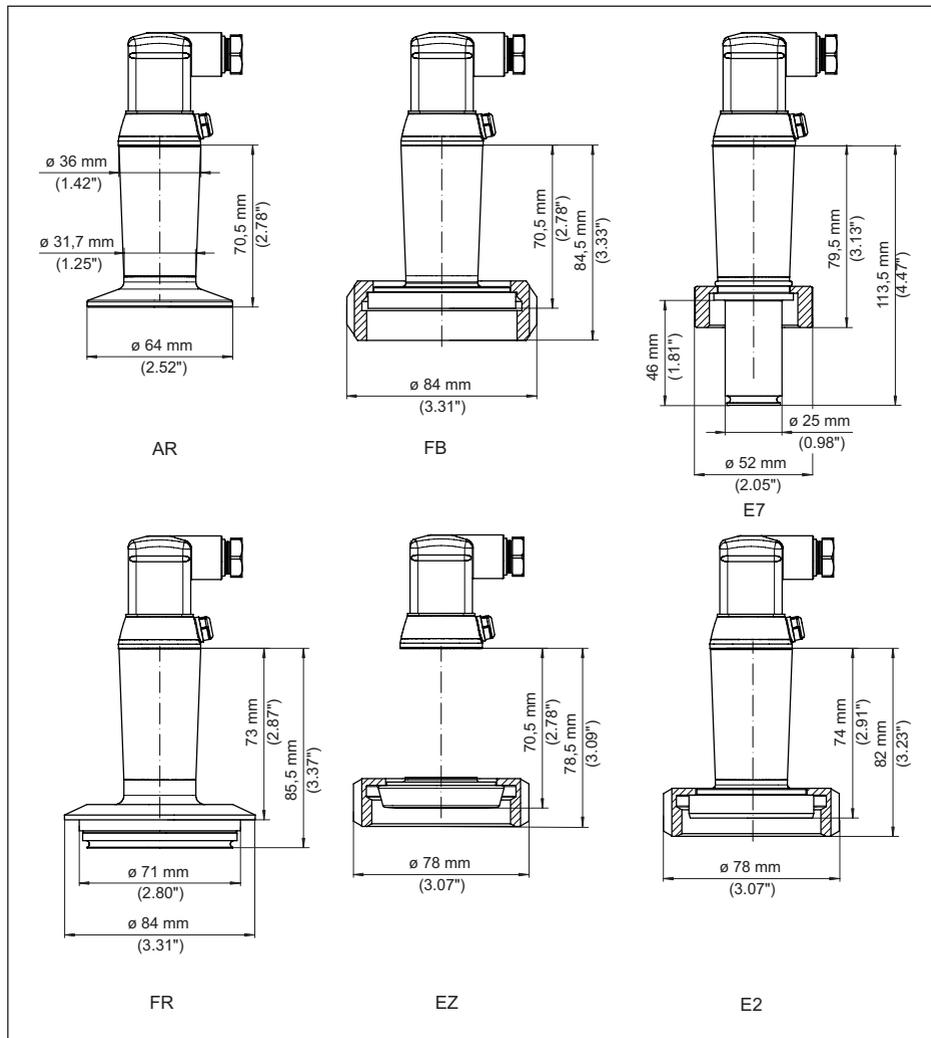
Fig. 33: VEGABAR 29, conexão asséptica
