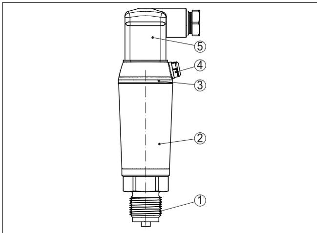
*Fig. 1: Componentes do VEGABAR 29*
