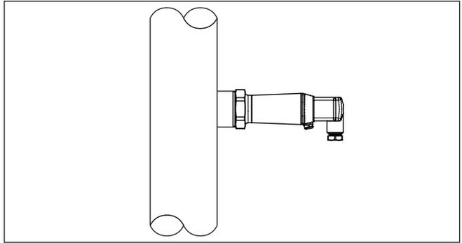
Fig. 3: Medição da pressão do processo com VEGABAR 29
