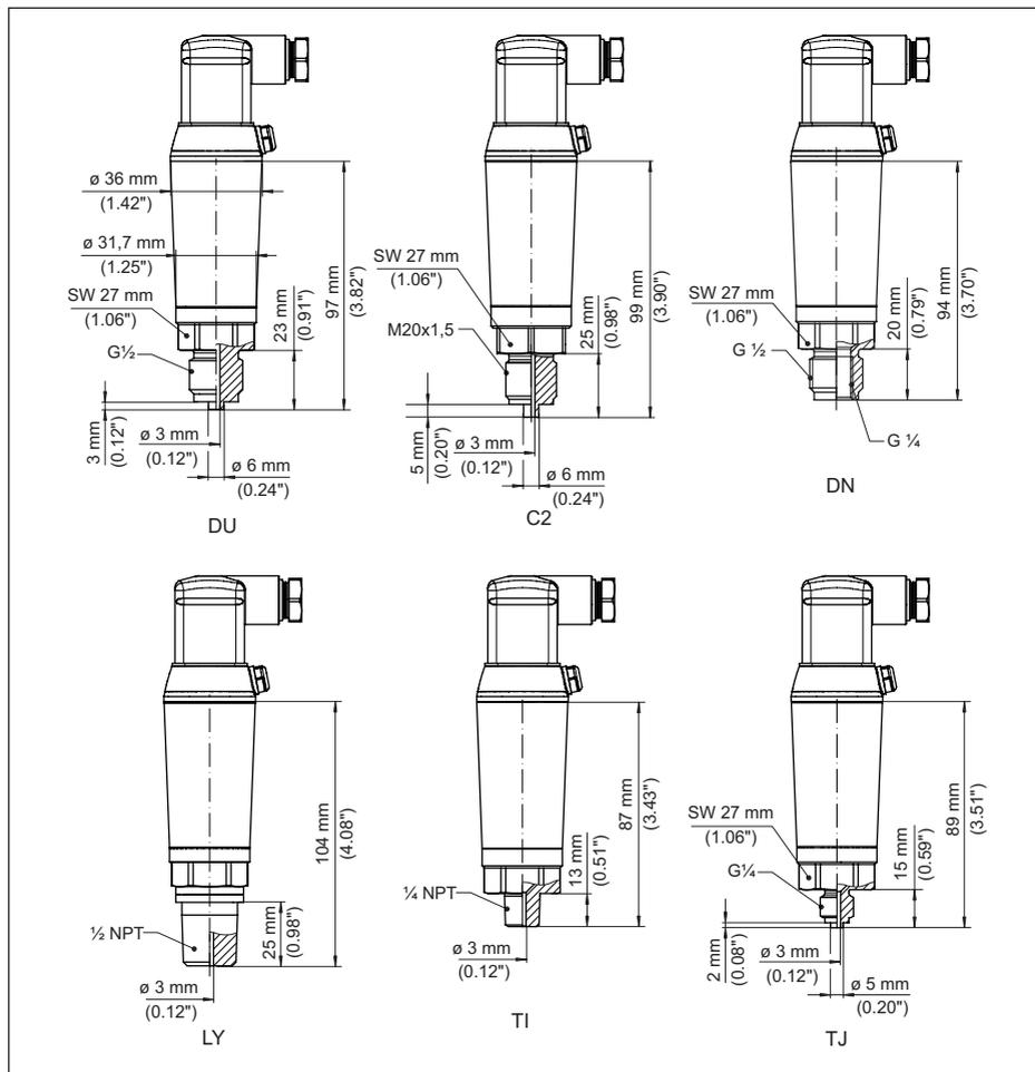
Fig. 30: VEGABAR 29, conexão rosçada não embutida na frente
