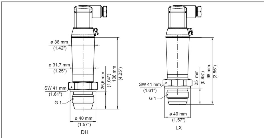
*Fig. 32: VEGABAR 29, Conexão de cone/tubo*
