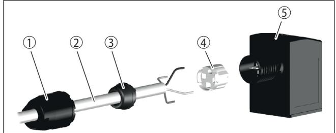
Fig. 17: Conexão conector de válvula ISO 4400 com técnica IDC
