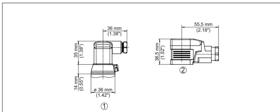
Fig. 29: Técnica de conexão VEGABAR 29
