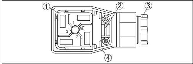
Fig. 15: Soltar a parte interna do conector
