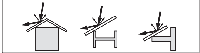
Fig. 12: Tapar los perfiles lisos con pantallas dispersoras
