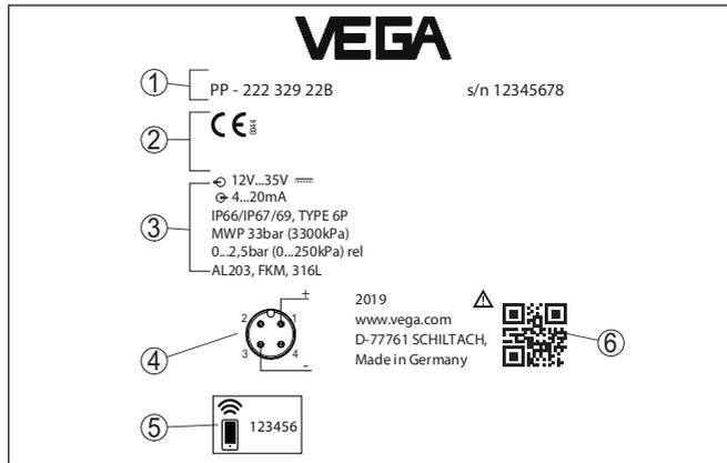
Fig. 2: Estructura de la placa de tipos (ejemplo)
