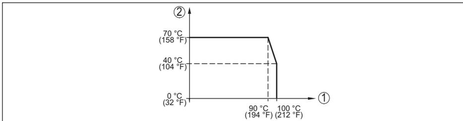
Fig. 31: Reducción de temperatura VEGABAR 39, con comunicación Bluetooth activada
