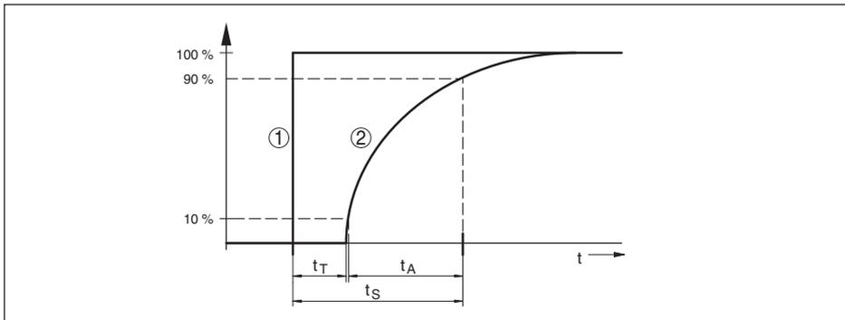
Fig. 28: Comportamiento de la salida de corriente en caso de cambio súbito de las magnitudes de proceso.  $t_T$ : tiempo muerto;  $t_A$ : tiempo de subida;  $t_S$ : tiempo de respuesta
