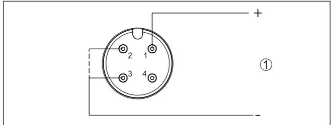
Fig. 19: Esquema de conexiones - dos hilos 4 ... 20 mA - conector M12 x 1
