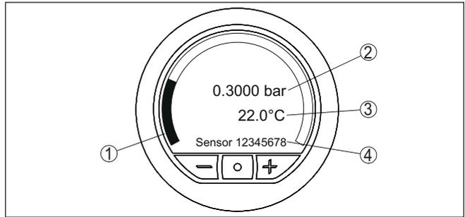
Fig. 21: Visualización de valor de medición con indicaciones adicionales
