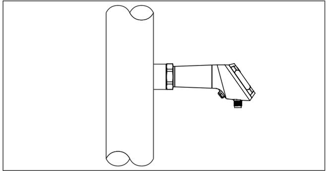
Fig. 3: Medición de presión de proceso con VEGABAR 39
