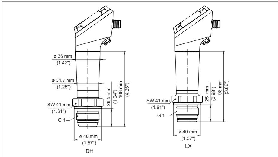
Fig. 36: VEGABAR 39, conexión de cono/tubo
