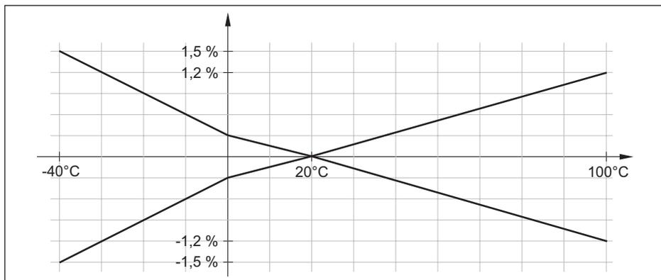
Fig. 29: Error de temperatura con TD 1 : 1
