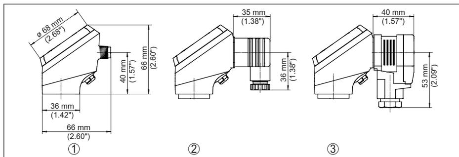
Fig. 33: Técnica de conexión VEGABAR 39
