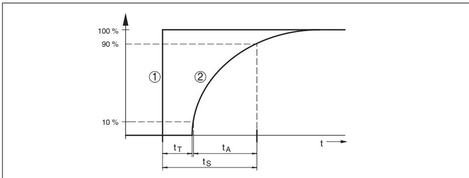
Fig. 32: Comportamiento de la salida de corriente en caso de cambio súbito de las magnitudes de proceso.  $t_T$ : tiempo muerto;  $t_A$ : tiempo de subida;  $t_S$ : tiempo de respuesta
