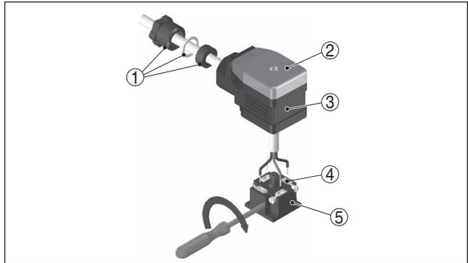
Fig. 16: Conexión a los bornes con tornillos
