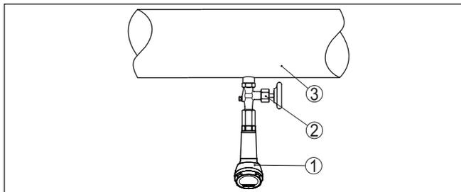
Fig. 11: Configuración de medición para la medición de presión de proceso de líquidos en tuberías
