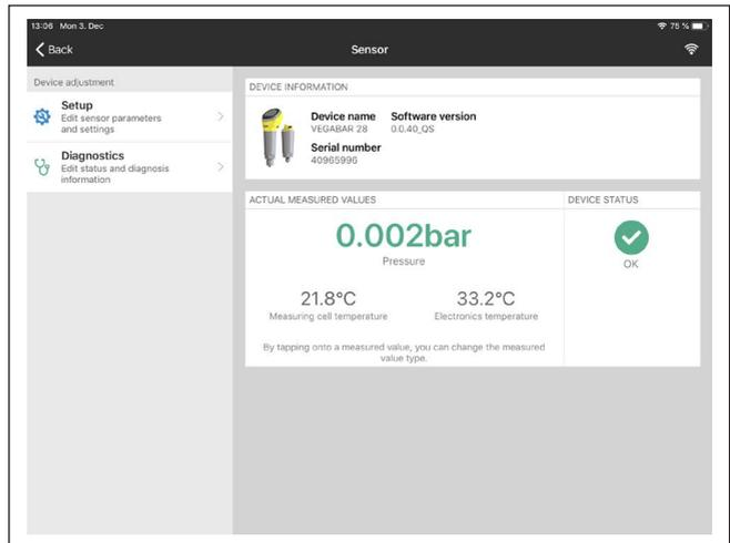
Fig. 24: Ejemplo de una vista de aplicación - puesta en marcha - valores de medición
