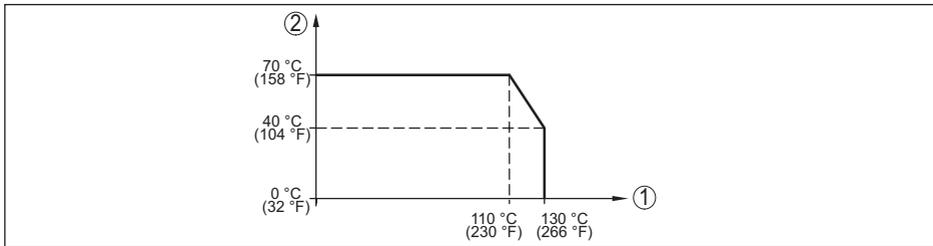
Fig. 30: Reducción de temperatura VEGABAR 39
