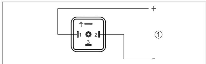
Fig. 18: Esquema de conexiones - dos hilos 4 ... 20 mA - conector según ISO 4400
