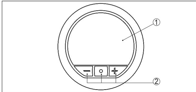
Fig. 22: Unidade de visualização e configuração integrada
