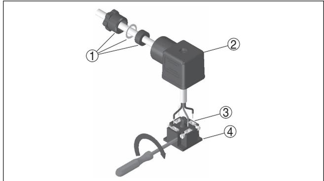
Fig. 16: Conexão nos terminais
