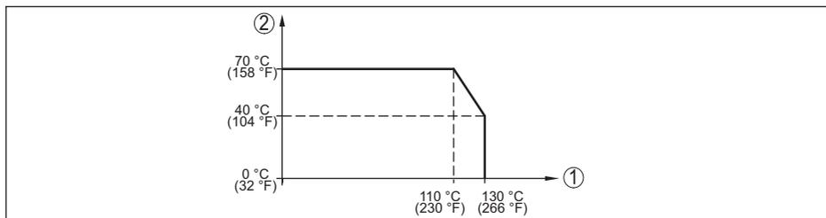
Fig. 32: Degradação da temperatura VEGABAR 38
