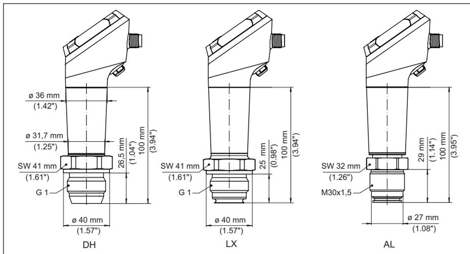
Fig. 37: VEGABAR 38, Conexão de cone/tubo
