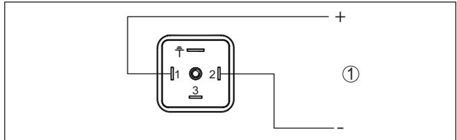
Fig. 20: Esquema de ligações - Dois condutores 4 ... 20 mA - conector segundo ISO 4400
