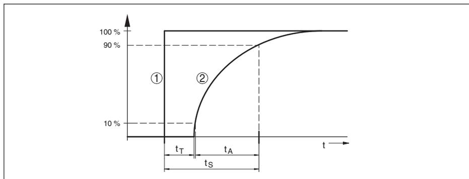
Fig. 30: Comportamento da saída de corrente em caso de alteração repentina da grandeza do processo.  $t_T$ : tempo morto;  $t_A$ : tempo de subida;  $t_S$ : tempo de resposta do salto
