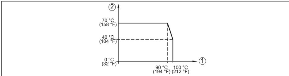
Fig. 33: Redução de temperatura VEGABAR 38, com comunicação com Bluetooth ativada
