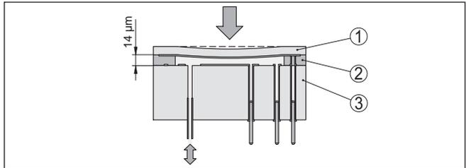
Fig. 4: *Estrutura da célula de medição Mini-CERTEC®*
