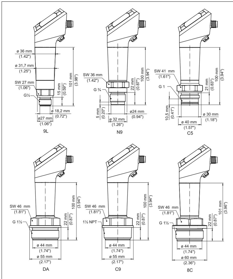
Fig. 36: VEGABAR 38, conexão rosca embutida na frente
