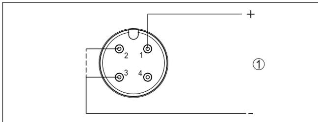
Fig. 21: Esquema de ligações - Dois condutores 4 ... 20 mA - conector M12 x 1
