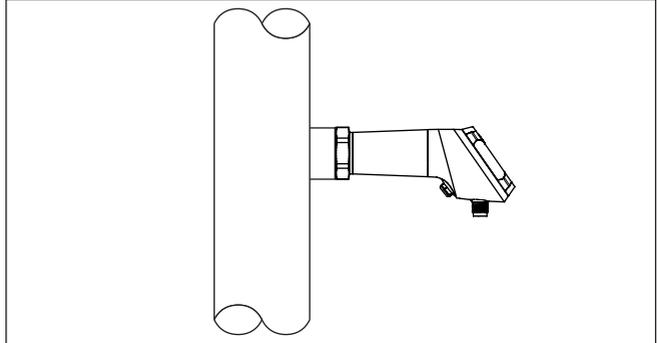
Fig. 3: *Medição da pressão do processo com VEGABAR 38*
