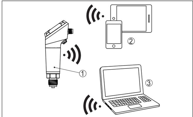
Fig. 8: Conexão sem fio com aparelhos de configuração padrão com Bluetooth integrado LE
