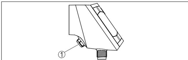
Fig. 9: Posição do elemento de filtragem
