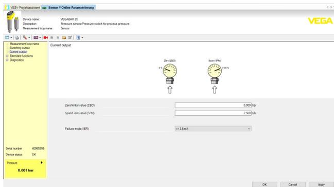
Fig. 28: Exemplo de uma visualização de DTM - Calibração saída de corrente
