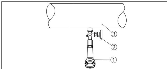
Fig. 13: Arranjo de medição na medição da pressão do processo de líquidos em tubos
