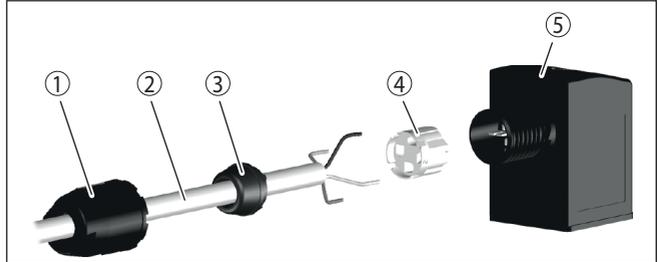
Fig. 19: Conexão conector de válvula ISO 4400 com técnica IDC
