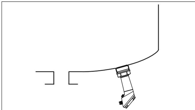
Fig. 14: Arranjo para a medição do nível de enchimento
