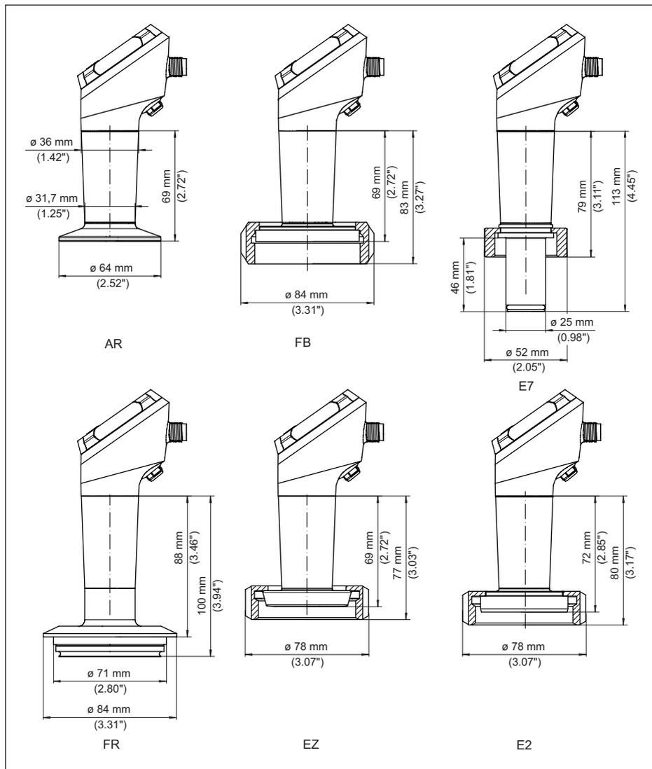
Fig. 38: VEGABAR 38, conexão asséptica
