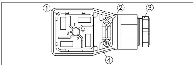
Fig. 17: Soltar a parte interna do conector
