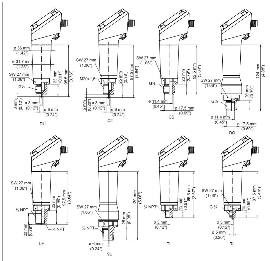
*Fig. 35: VEGABAR 38, conexão rosçada não embutida na frente*
