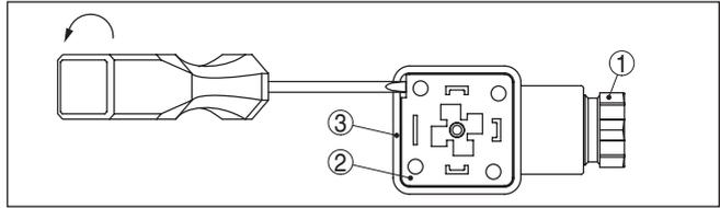
Fig. 15: Soltar a parte interna do conector
