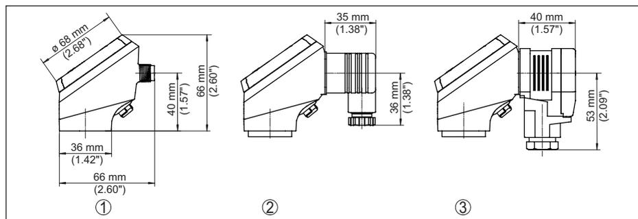
Fig. 34: Técnica de conexão VEGABAR 38
