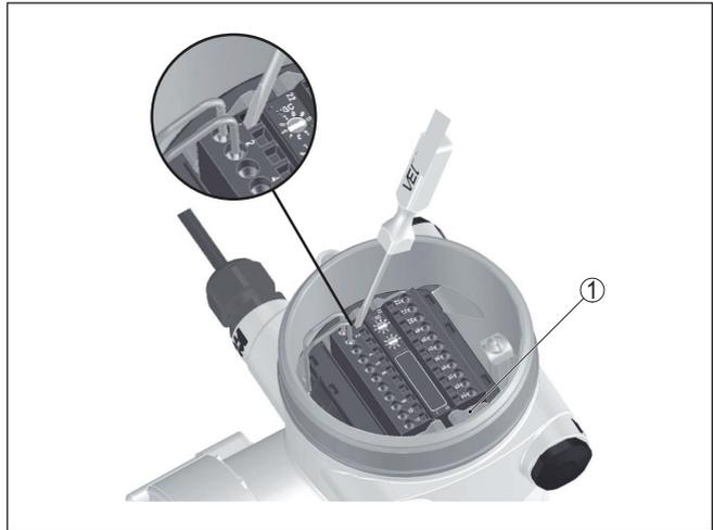
Fig. 8: Étapes de raccordement 4 et 5
