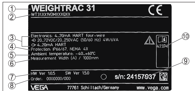
Rys. 1: Struktura tabliczki znamionowej (przykład)
