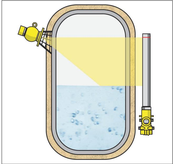
*Fig. 7: Medição de nível de enchimento em um reservatório aquecido com isolamento térmico*
