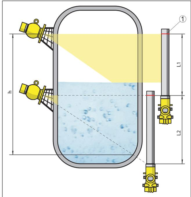
Fig. 6: Posição de montagem - Disposição em cascata
