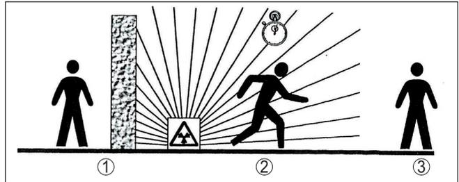
Fig. 3: Medidas para a proteção contra radiação
