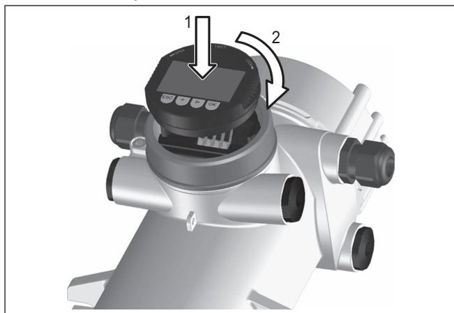
Fig. 18: Colocar o módulo de visualização e configuração
