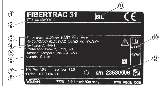
Abb. 1: Aufbau des Typschildes (Beispiel)
