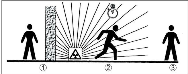
Abb. 3: Maßnahmen zum Schutz vor radioaktiver Strahlung
