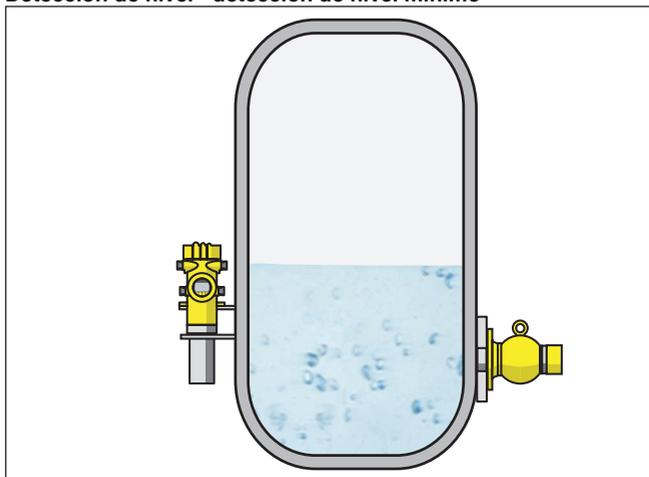
Fig. 8: POINTRAC 31 como detección de nivel mínimo (cubierto)
