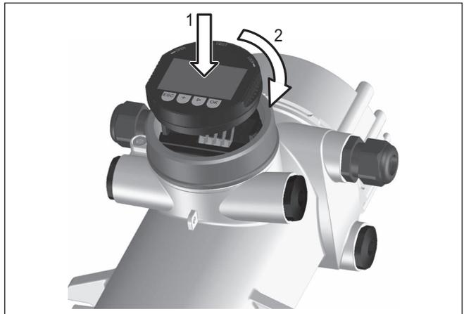
Fig. 15: Colocar el módulo de visualización y configuración
