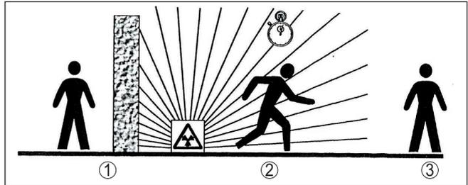
Fig. 3: Medidas de protección contra radiación radioactiva
