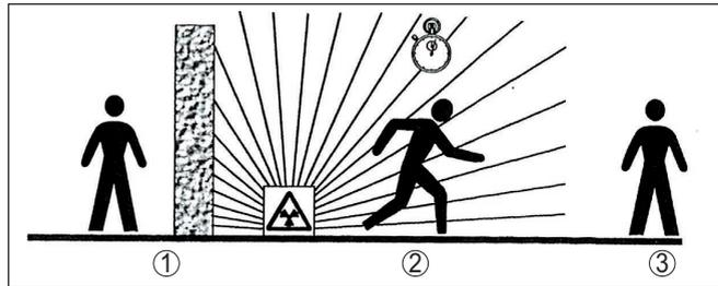
Fig. 4: Medidas para a proteção contra radiação
