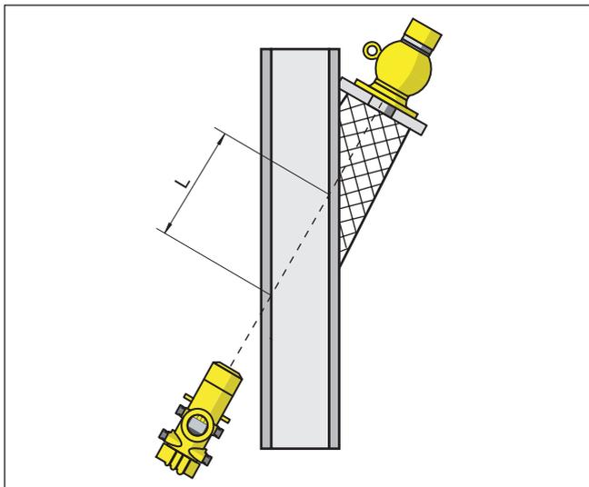
Fig. 21: No caso de montagem oblíqua, vale o comprimento do tubo atravessado pelos raios
