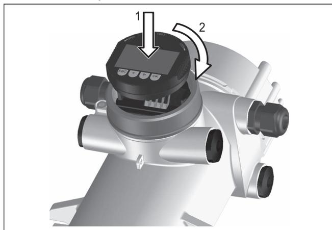
Fig. 20: Colocar o módulo de visualização e configuração
