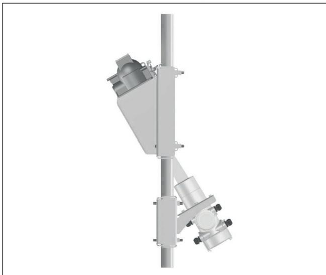
*Fig. 9: Disposição de medição em 30° em um tubo com diâmetro 50 ... 100 mm (1.97 ... 3.94 in)*
