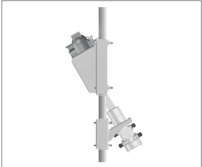
Fig. 9: 30°-meetopstelling op een leiding met diameter 50 ... 100 mm (1.97 ... 3.94 in)
