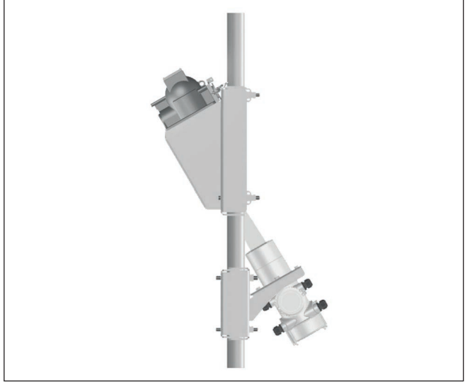
Res. 9: 50 ... 100 mm (1.97 ... 3.94 in) çaplı olan bir boru tesisatında 30°-ölçüm düzeni
