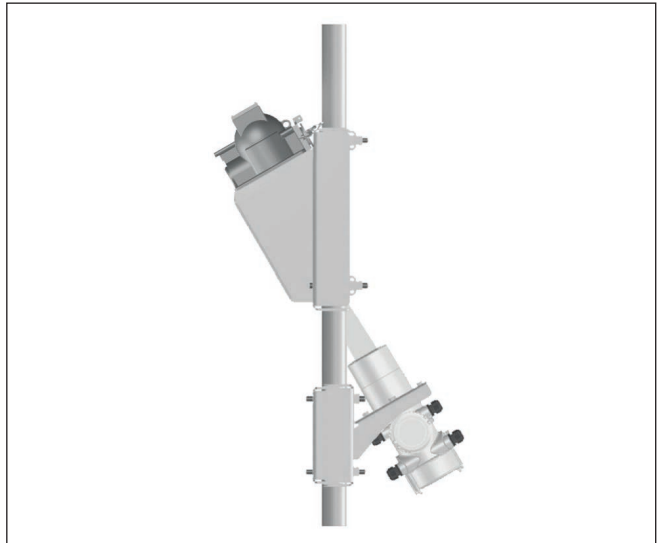
Abb. 9: 30°-Messanordnung an einer Rohrleitung mit Durchmesser 50 ... 100 mm (1.97 ... 3.94 in)
