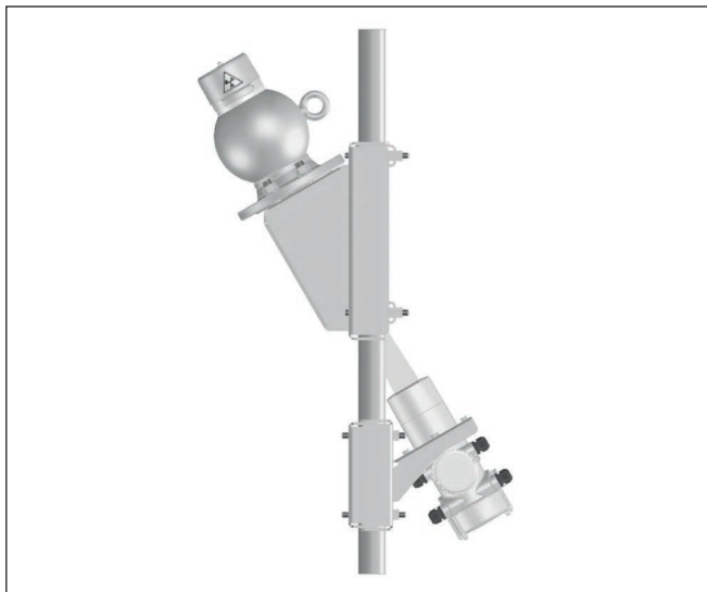
Rys. 7: Rozmieszczenie układu pomiarowego 30^\circ na rurociągu o średnicy w zakresie 50 ... 100 mm (1.97 ... 3.94 in)
