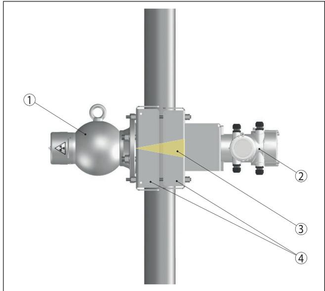
Figura 9: Configurazione per la misurazione su una tubazione con diametro di 50 ... 420 mm (1.97 ... 16.54 in), montaggio orizzontale del rilevatore
