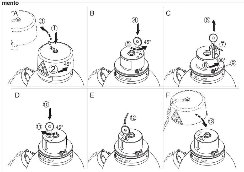
Figura 11: Attivazione dell'irraggiamento - VEGASOURCE 35 modello A
