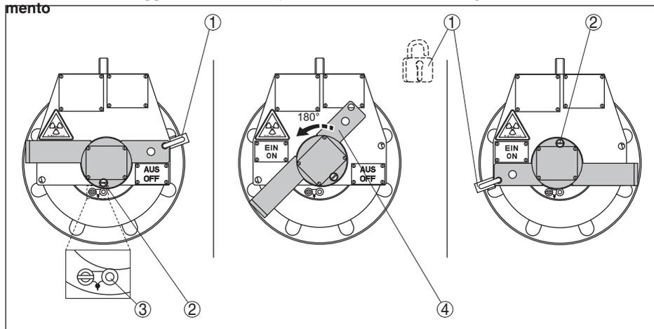
Figura 13: Attivazione dell'irraggiamento - VEGASOURCE 35 modello C, E
