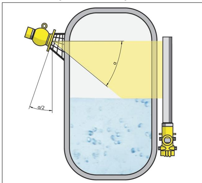
Figura 4: Orientamento - contenitore di protezione
