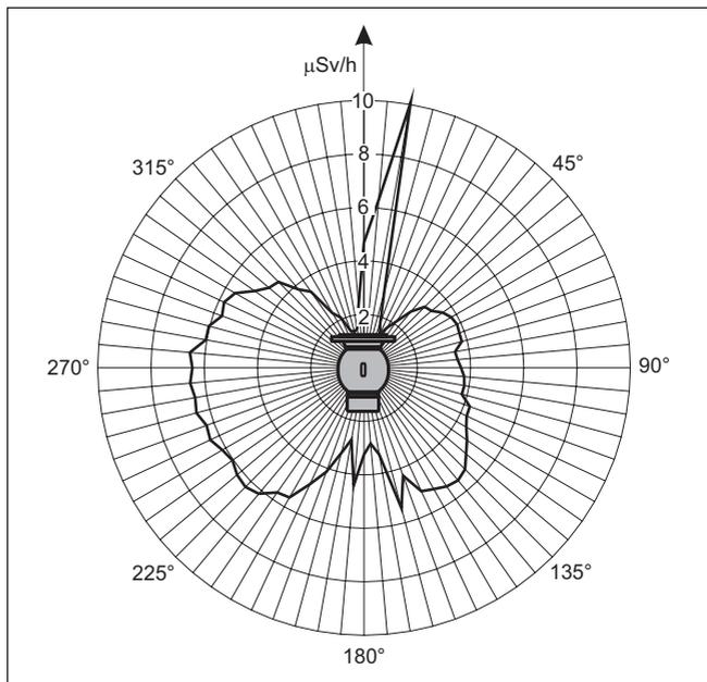
Figura 19: Curva di isodistanza (distanza: 1 m) - esempio: contenitore di protezione VEGASOURCE 35 con Co-60, 100 mCi (3,7 GBq)
