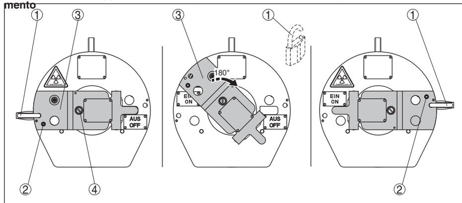
Figura 14: Attivazione dell'irraggiamento - VEGASOURCE 35 modello D
