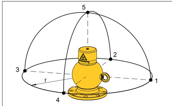
Figura 17: Punti di misura per la misura dell'intensità di dose ambientale
