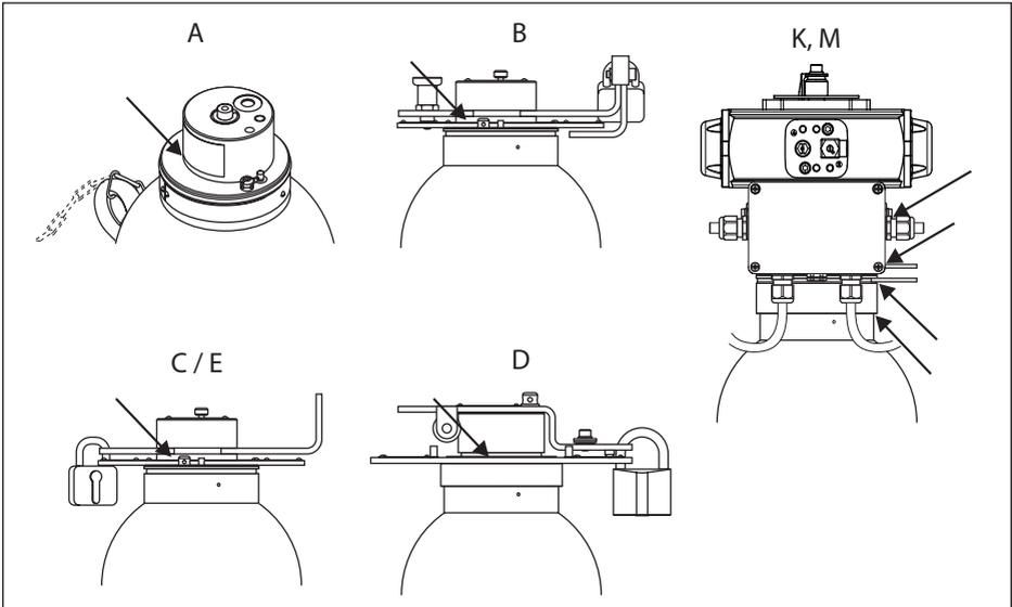
Figura 18: Superfici di strofinamento per la prova di tenuta
