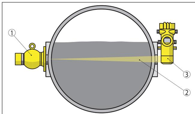
Figura 10: Configurazione di misura su una tubazione orizzontale
