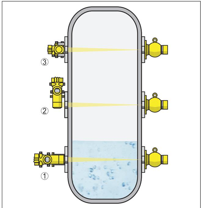
Figura 5: Posizioni di montaggio - rilevamento di soglia di livello con MINI-TRAC 31
