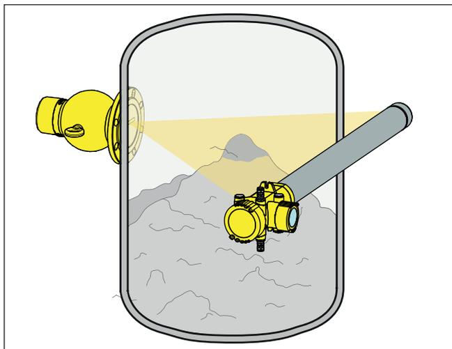
Figura 6: Rilevamento di soglia di livello con SOLITRAC 31
