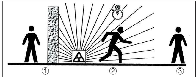
Figura 1: Provvedimenti per la protezione da fonti radioattive
