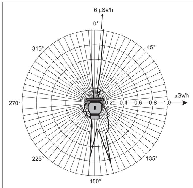
Figura 20: Curva di isodistanza (distanza: 1 m) - esempio: contenitore di protezione VEGASOURCE 35 con Cs-137, 1000 mCi (37 GBq)
