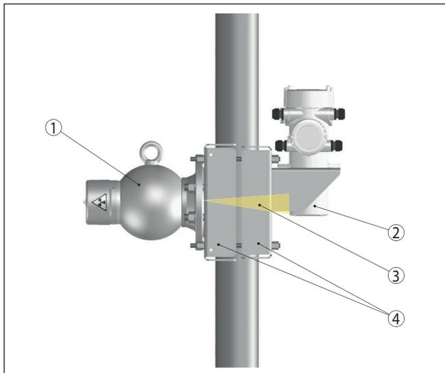
Figura 8: Configurazione per la misurazione su una tubazione con diametro di 50 ... 420 mm (1.97 ... 16.54 in), montaggio verticale del rilevatore
