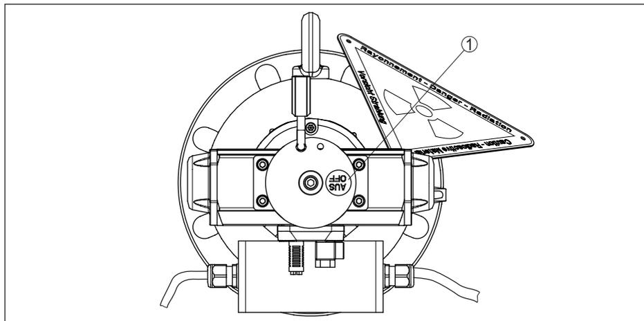
Figura 16: Visualizzazione dello stato di commutazione di VEGASOURCE 35 - modello K, M
