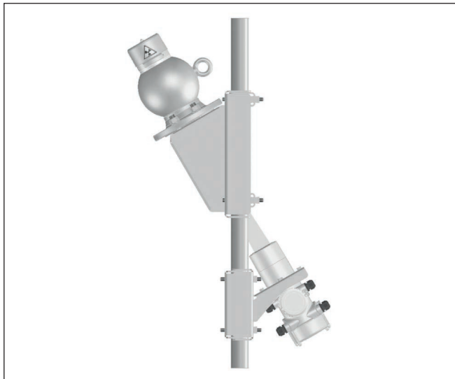
Fig. 7: 30°-meetopstelling op een leiding met diameter 50 ... 100 mm (1.97 ... 3.94 in)
