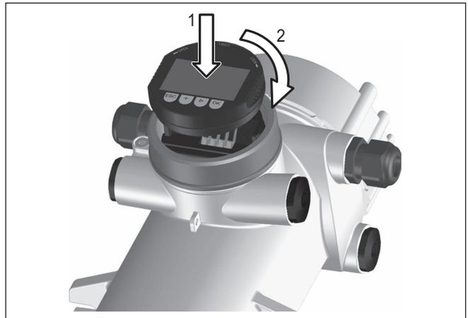
Fig. 19: Colocar el módulo de visualización y configuración
