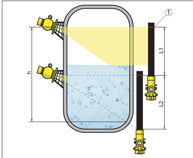
Fig. 6: Posición de montaje - En cascada
