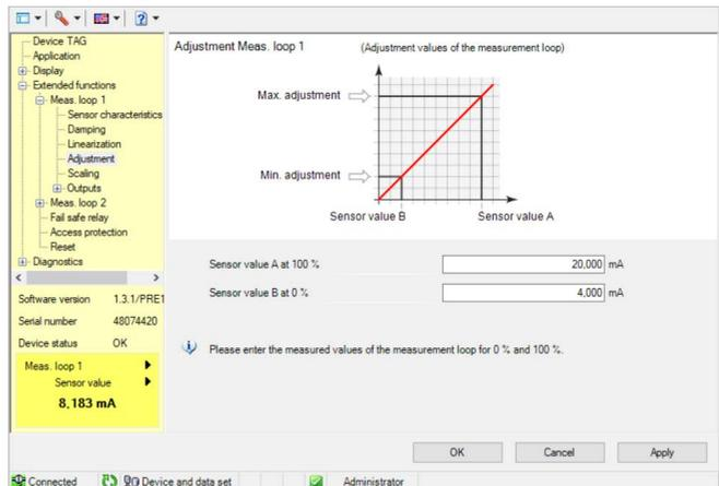
Fig. 14: Ejemplo de una vista DTM - Ajuste
