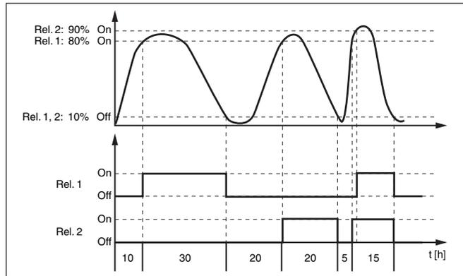
Fig. 18: Ejemplo para el control de bomba 2
