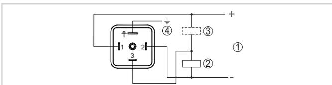
Esquema de conexiones conector ISO 4400 - Salida de transistor, tres hilos.
