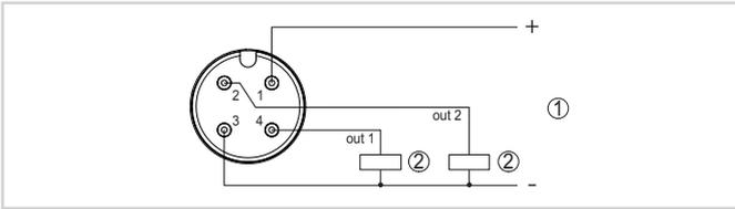
Esquema de conexiones conector M12 x 1 - Salida de transistor, tres hilos.
