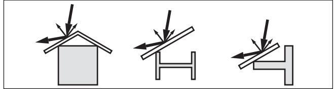
Fig. 13: Tapar los perfiles lisos con pantallas dispersoras
