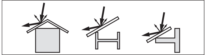
Fig. 13: Recouvrir les obstacles lisses par des déflecteurs
