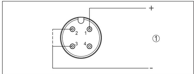
Fig. 18: Schéma de raccordement - deux fils 4 ... 20 mA - connecteur M12 x 1
