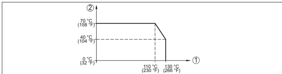
Fig. 28: Derating de température VEGABAR 29
