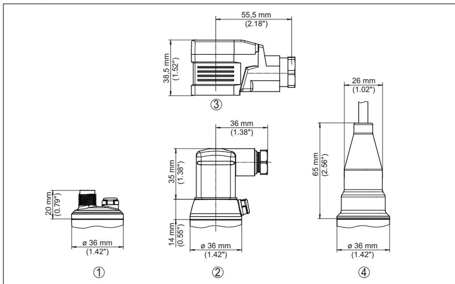
Fig. 30: Technique de raccordement VEGABAR 29
