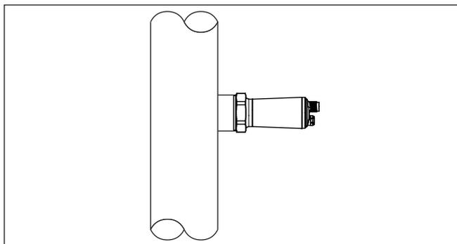
Fig. 3: Mesure de pression process avec VEGABAR 29
