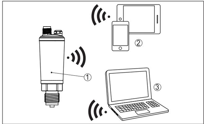
Fig. 6: Connexion sans fil aux outils de réglage standard avec Bluetooth intégré LE
