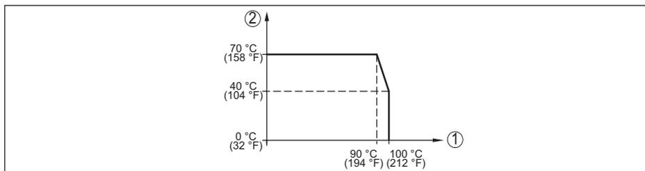
Fig. 29: Dérivage de température VEGABAR 29, avec la communication Bluetooth activée
