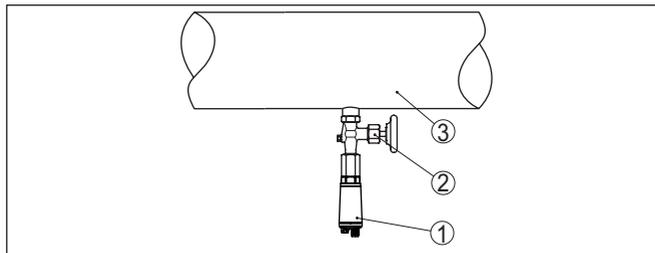
Fig. 11: Mise en œuvre pour la mesure de pression process de liquides dans des conduites
