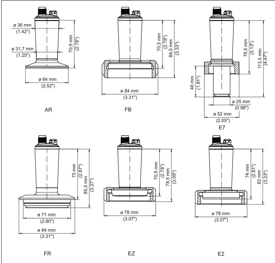
Fig. 34: VEGABAR 29, raccord aseptique
