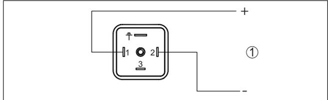
Fig. 19: Schéma de raccordement - deux fils 4 ... 20 mA - connecteur selon ISO 4400
