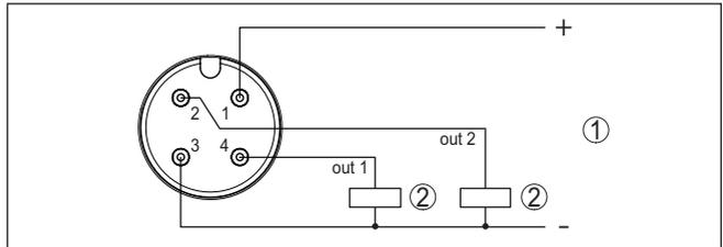
Figura 7: Schema di collegamento connettore M12 x 1 - uscita a transistor, trifilare
