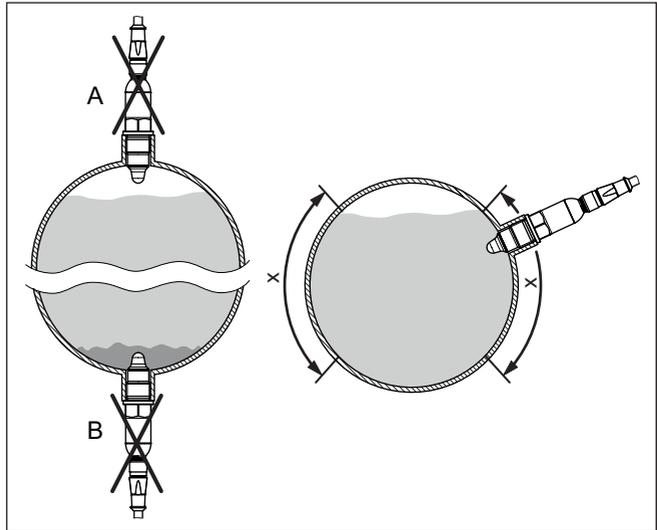
Figura 5: Montaggio in tubazioni orizzontali
