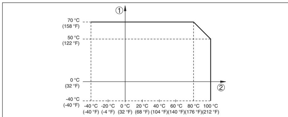
Figura 8: Relazione fra temperatura ambiente e temperatura di processo
