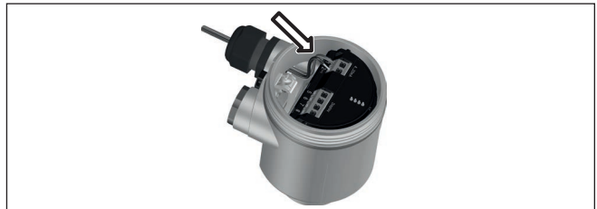
Rys. 6: Czynności przy podłączeniu 5 i 6 - obudowa jednokomorowa
