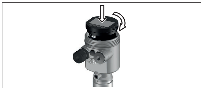
Figura 9: Inserimento del tastierino di taratura con display nel vano dell'elettronica in caso di custodia ad una camera
