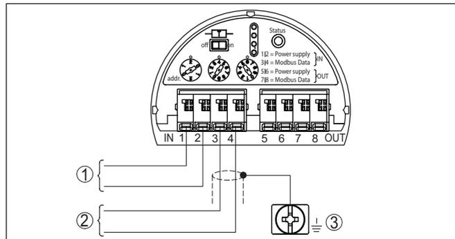
Fig. 9: compartimento do sistema eletrônico - Conexão com ramal
