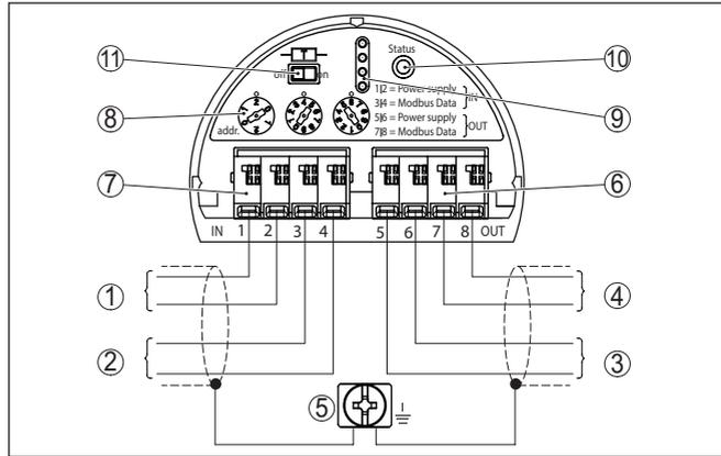
Fig. 8: Compartimento do sistema eletrônico - Conexão da Daisy-Chain
