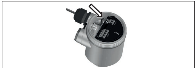
Rys. 3: Czynności przy podłączeniu 5 i 6 - obudowa jednokomorowa
