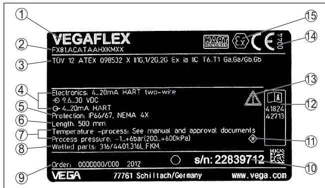
Rys. 1: Struktura tabliczki znamionowej (przykład)
