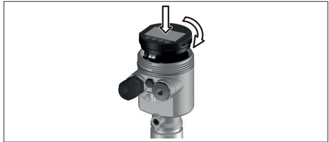
Fig. 6: Empleo del módulo de visualización y configuración en carcasa de una sola cámara el compartimento de conexión
