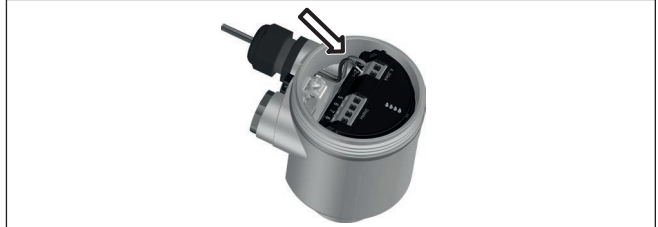
Fig. 6: Aansluitstappen 5 en 6 - eenkamerbehuizingen
