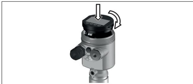
Fig. 18: Colocação do módulo de visualização e configuração na caixa de uma câmara no compartimento do sistema eletrônico
