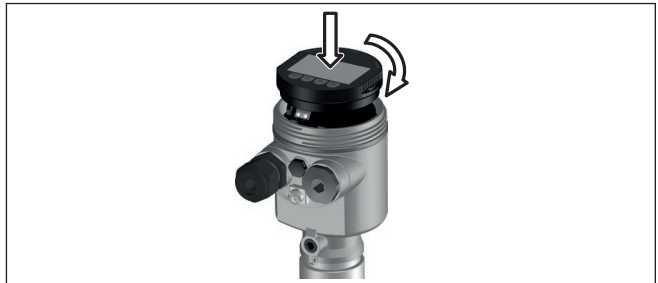
Fig. 18: Plaatsen van de display- en bedieningsmodule bij eenkamerbehuizing in elektronicaruimte.
