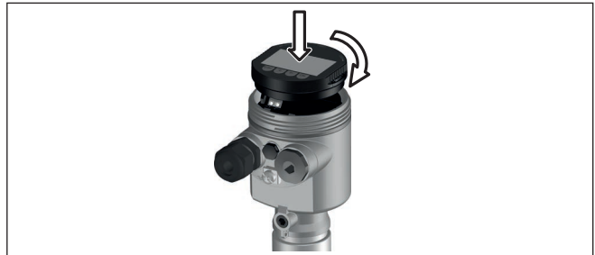
Fig. 14: Colocação do módulo de visualização e configuração na caixa de uma câmara no compartimento do sistema eletrônico
