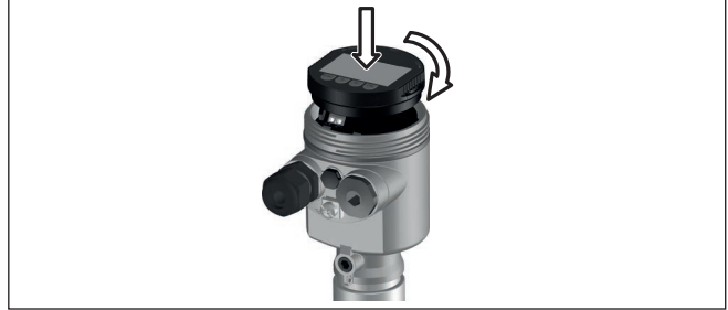
Res. 14: Elektronik bölümünde bir hücreli gövdede gösterge ve ayar modülünün çalıştırılması
