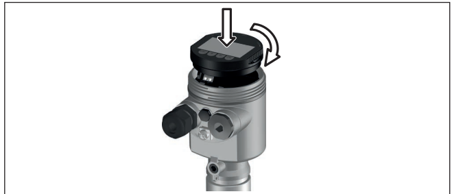
Abb. 14: Einsetzen des Anzeige- und Bedienmoduls beim Einkammergehäuse im Elektronikraum
