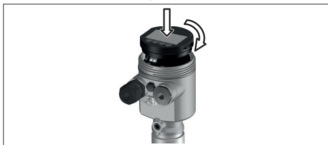
Fig. 13: Montage du module d'affichage et de réglage dans le boîtier à chambre unique se trouvant dans le compartiment de l'électronique
